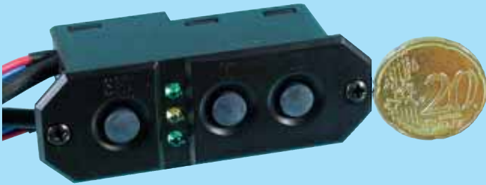
Klein, aber fein: Die Powerbox-Sensor. Der Einschaltvorgang wird durch die Taste ganz links eingeleitet, mit den beiden rechten werden die beiden einzelnen Akkus ein- bzw. ausgeschaltet. Über die LEDs wird angezeigt, welcher Akku am Netz hängt oder nicht
