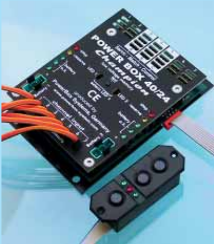
Der „Champion“ von Deutsch: Die Powerbox 40/24 inklusive Schaltmodul, das über ein Flachbandkabel mit der Weiche kommuniziert. Das Schaltmodul löst den Schaltvorgang innerhalb der Akkuweiche aus, die Akkus werden also ohne Schalterkabel zwischen Akku und Weiche direkt über die Hochstromstecker an die Platine angeschlossen
