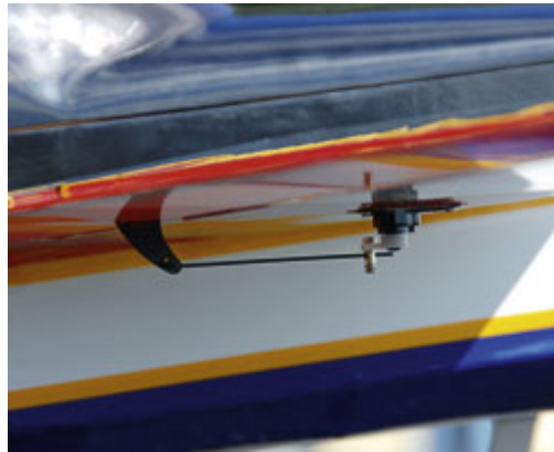
Alle Anlenkungen, hier ein Querruder, sind kurz und präzise – so soll es sein!
