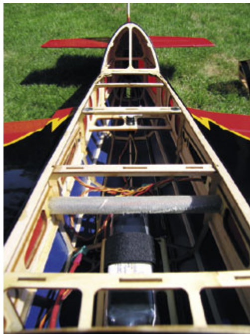
Absolute Leichtbauweise zeichnet das Modell aus. Der Flugakku verliert sich fast zwischen den Verstrebungen
