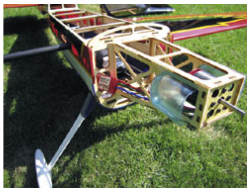
Zwecks besserer Kühlung wurden die zwei Lufthutzen unter die Motorhaube gebaut. Der Kontronik-Motor erwies sich als idealer Antrieb
