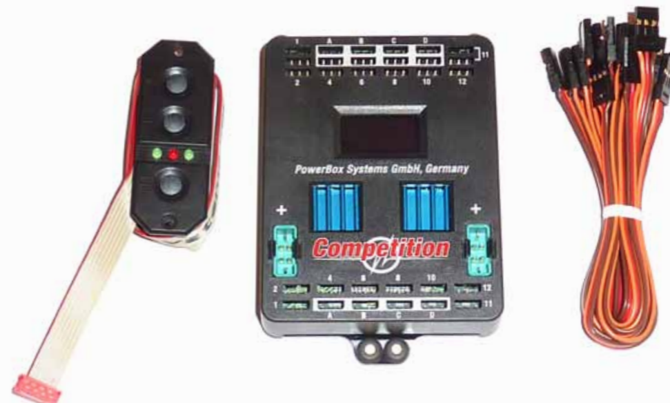
Zum Lieferumfang gehört neben der Weiche und dem Sensorschalter ein Bündel Patchkabel zum Anschluss des Empfängers. Die gelungene Konstruktion ermöglicht bei geringen Abmessungen und Gewicht den komfortablen Anschluss aller Komponenten. Im unteren Bereich der Weiche wird der Empfänger und im oberen Bereich werden die Servos angeschlossen. Der Sensorschalter sorgt für sichere Ein- und Ausschaltvorgänge, außerdem erfolgt der Dialog mit der Weiche mithilfe des Schalters
