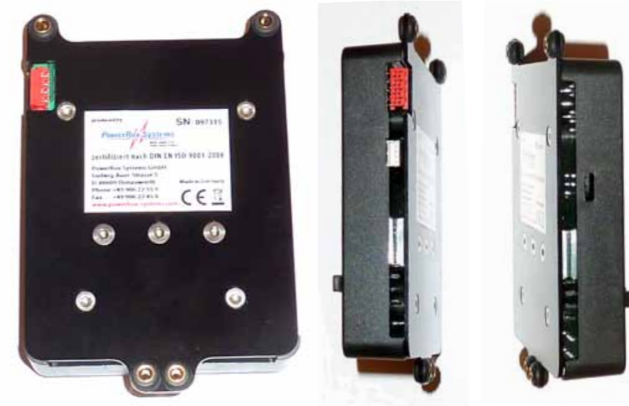
Die Befestigungsplatte auf der Unterseite dient gleichzeitig als Kühlkörper. Im rechten Seitenteil befindet sich der Port für das Spektrum-Telemetriemodul und die Anschlussbuchse des Sensorschalters. Linksseitig wird die Verbindung zum Sensorbus eines M-LINK-Empfängers hergestellt
